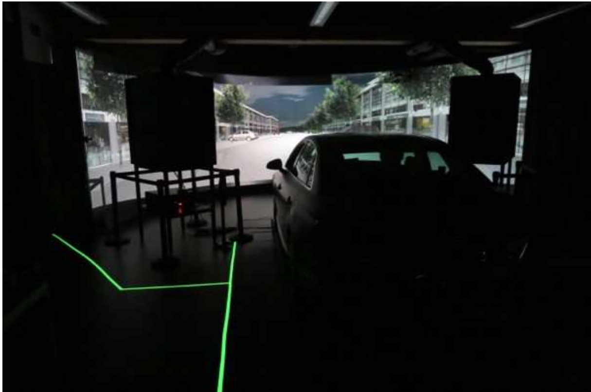
Abbildung 3b: Versuchsaufbau im Fahrsimulator – das Testfahrzeug befindet sich zwischen den beiden aus Gründen der Kühlung und Klimatisierung eingehausten Velvet-Hochleistungsbeamern der Firma Zeiss. Als „Virtual Reality“-Szenario dient hier das Campusgelände der Hochschule Aalen; auf diese Weise können die Simulatorversuche unmittelbar nachfolgend unter vergleichbaren Bedingungen im Realversuch validiert werden.
