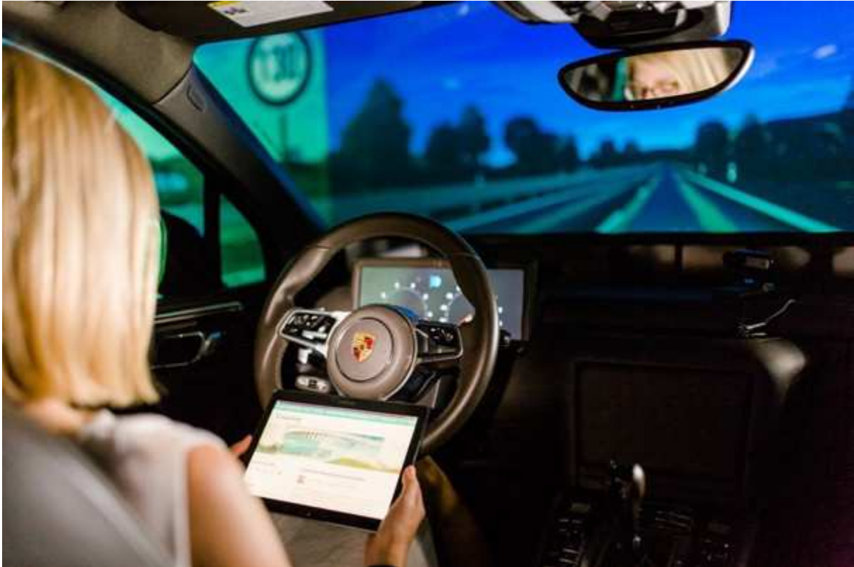
Abbildung 5: Immersiver Fahrsimulator (Porsche Macan) im „Vehicle Interaction Lab“ der Arbeitsgruppe „Ergonomics and Vehicle Interaction“ am Fraunhofer-Institut für Arbeitswirtschaft und Organisation zur Untersuchung der Mensch-Fahrzeug-Interaktion. © Ludmilla Parsyak, Fraunhofer IAO
